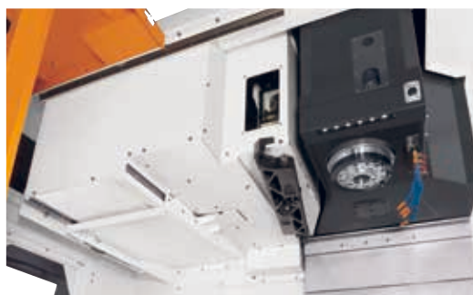
刀臂式ATC + 刀倉自動門 + 環噴冷卻液 + LED工作燈
