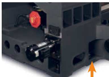
增加墊塊支撐立柱
