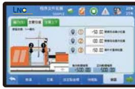
車床機器人，安全區域設定，可避免撞機情形。
