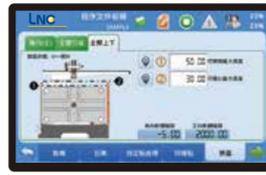
自動化機器人，安全區域設定，可避免撞機情形。
